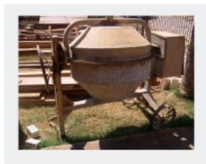
Betoneira sem proteção
