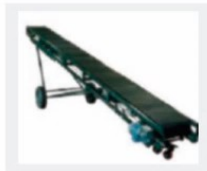
Esteira sem Proteção
