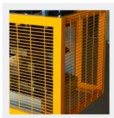
Fig. 1: Proteção com abertura quadrada de 30 mm A distância de segurança ("Sr") até a área de perigo deve ser maior que 120 mm.
