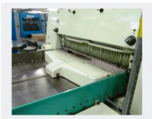
Esquadro sem proteção
