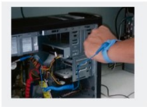
Pulseira contra energia eletroestática para proteção da máquina durante o manuseio
