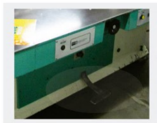
Pedal sem proteção
